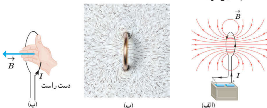
شکل ۱۷-۳ (الف) خط‌های میدان مغناطیسی در اطراف یک حلقه حامل جریان. (ب) طرح خط‌های میدان مغناطیسی یک حلقه حامل جریان با استفاده از براده آهن. (پ) استفاده از قاعده دست راست برای تعیین جهت B یک حلقه حامل جریان.
