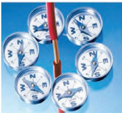
شکل ۳-۱۴ میدان مغناطیسی اطراف سیم حامل جریان را می‌توان با قرار دادن تعدادی عقربه مغناطیسی پیرامون آن نشان داد.
