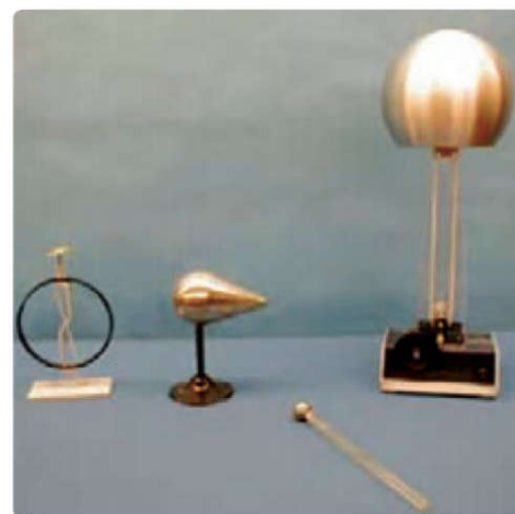
شکل ۱-۳۳ اسباب آزمایش چگونگی توزیع بار روی سطح خارجی یک جسم رسانای باردار
