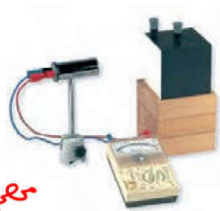
شکل ۴-۳۳ درون مکعب لسی، آب داغ می‌ریزند. تابش گرمایی از چهار وجه مکعب که رنگ‌های متفاوتی دارند، با هم فرق دارد.
