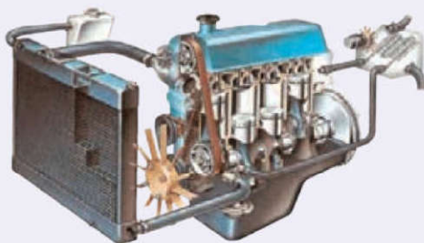
شکل ۱۸-۴ تصویری از سیستم خنک کننده خودرو
